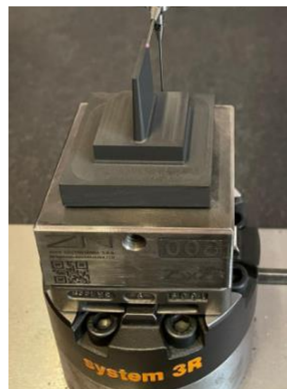
Obrázek 16 Měření elektrody na CMM
