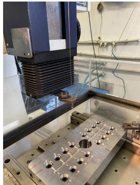
Obrázek 8 Příprava na vrtání startovacích otvorů pro EDM řezání [Vlastní zdroj]
