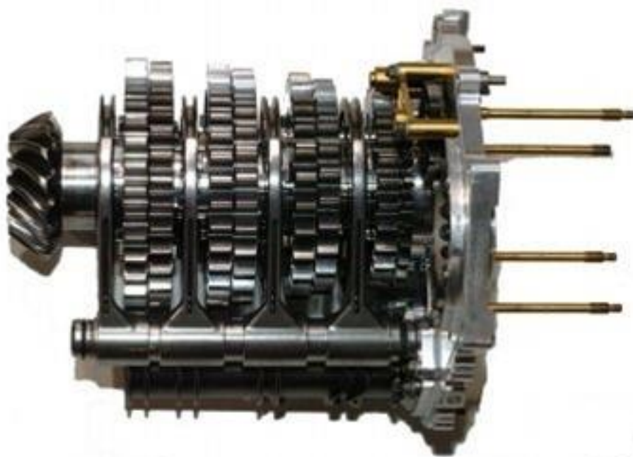
Obr. č. 1: Sekvenčně řazená převodovka používaná v F1 – Scuderia Ferrari (2003) [1]
