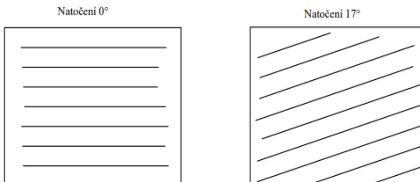
Obr. 31 Zvolená strategie šrafovaní: vlevo – natočení šrafovaní pro první přejezd; vpravo – natočení šrafovaní pro druhý přejezd
