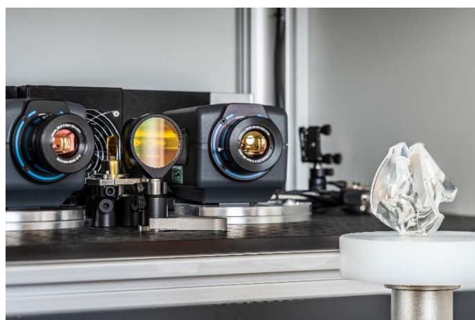
Obrázek 30 Konfigurace kamer a laserového zdroje přístroje Glass360Dgree [28]
