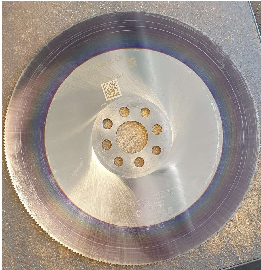
Obrázek 2 - Celistvý pilový kotouč s povlakem TiAlN - vlastní
