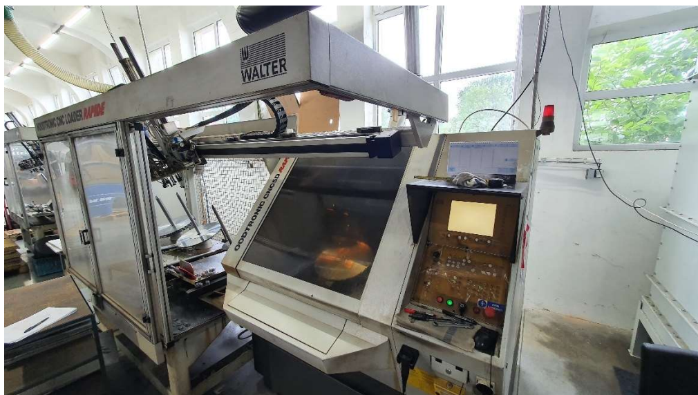
Obrázek 27 - Walter Woodtronic CNC 5D rapide – stroj pro broušení plátkových kotoučů - vlastní
