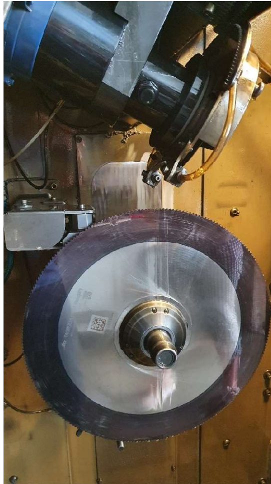
Obrázek 26 - Stroj na ostření HSS pilových kotoučů, pracující pod olejem – vlastní
