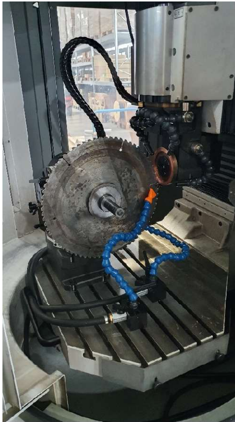
Obrázek 28 - Proces elektroerozivního broušení - vlastní
