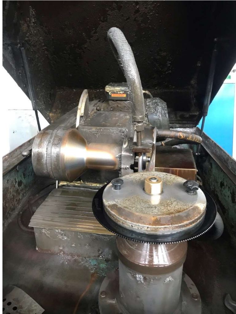
Obrázek 25 - Vnitřek brusky chlazené 5% emulzí - vlastní
