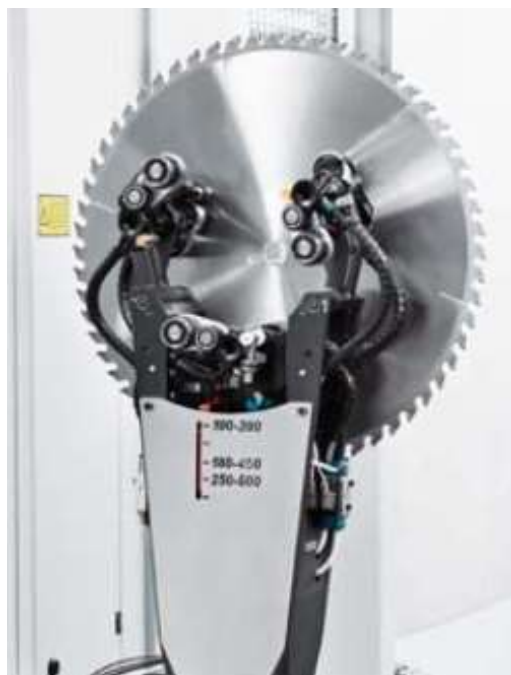
Obrázek 29 - upínací systém u brusky Volmer CHD 270 do \varnothing 630 mm [27]
