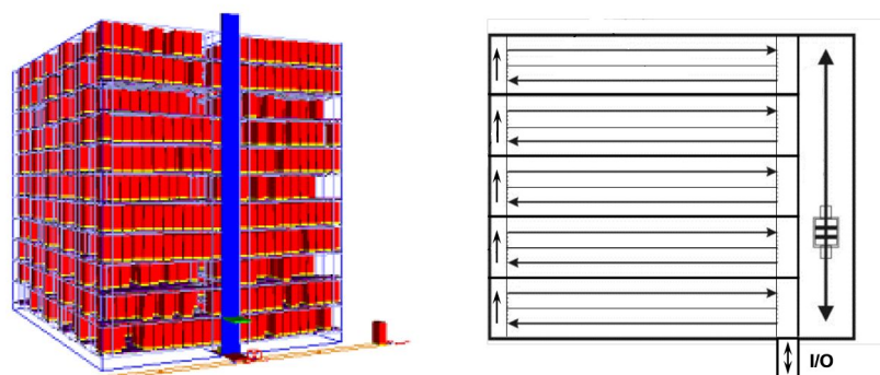
Obrázek 4.6: Kompaktní AS/RS a jeho princip, zdroj: [24]
