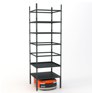
Obrázek 4.14: Robotické vozítka, také označované jako kiva robot, zdroj: [24]
