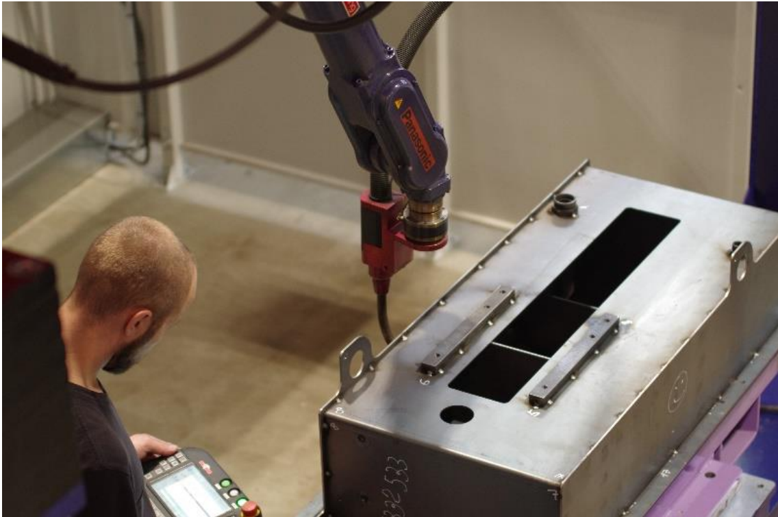
Obrázek 11: Olejový tank svařovaný robotem
