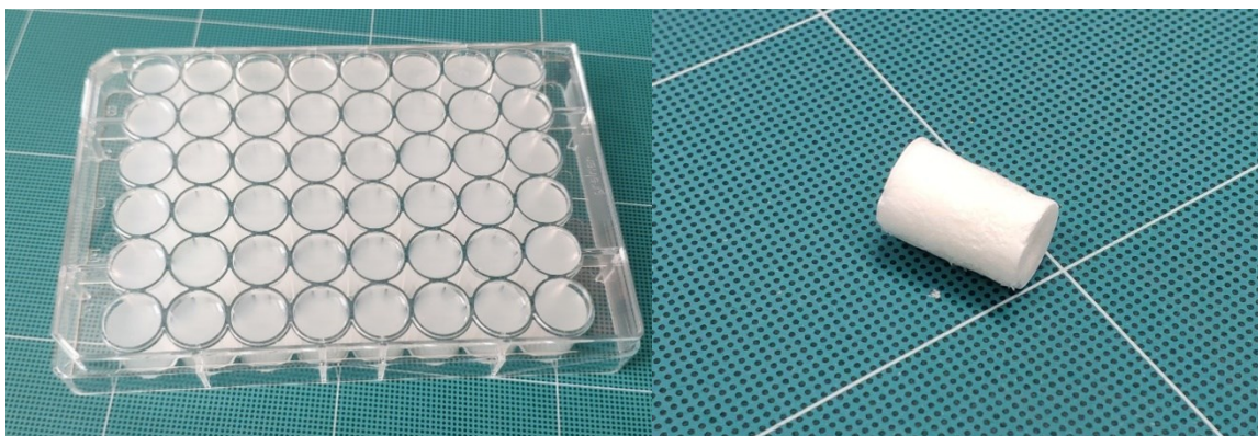
Obrázek 3: Příprava kolagenních scaffoldů. Vlevo kolagenní disperze ve 48jamkovém kultivačním plastu, vpravo lyofilizovaný scaffold připravený na experimenty.
