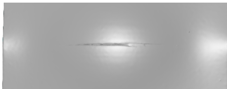
Obr. 6.24: Porušený experimentální vzorek NAK80
