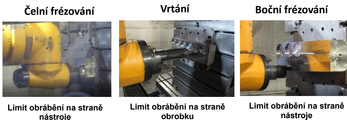
Obrázek 3.30 – Zkoušky obráběním – testované operace
