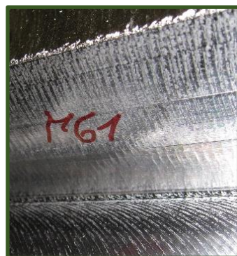
Obrázek 3.26 – Porovnání záznamů kmitání při obrábění s frézou D80/Z3
