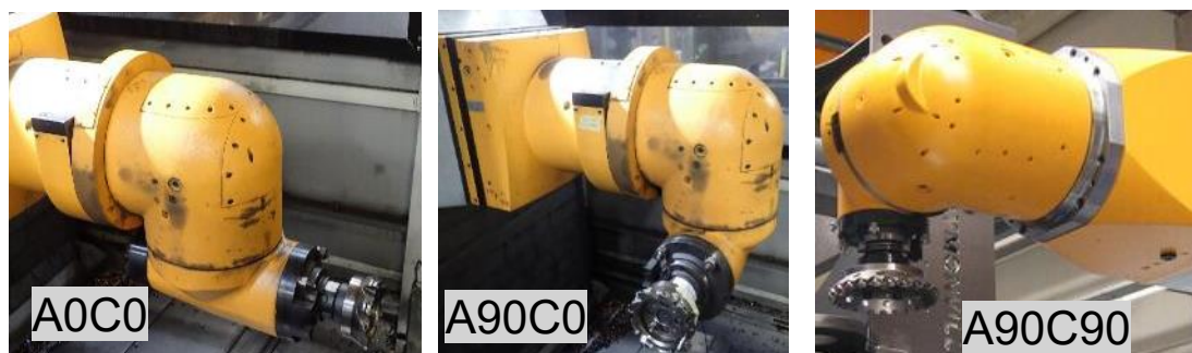
Obrázek 3.32 – Polohy vřetenové hlavy pro měření FRF
