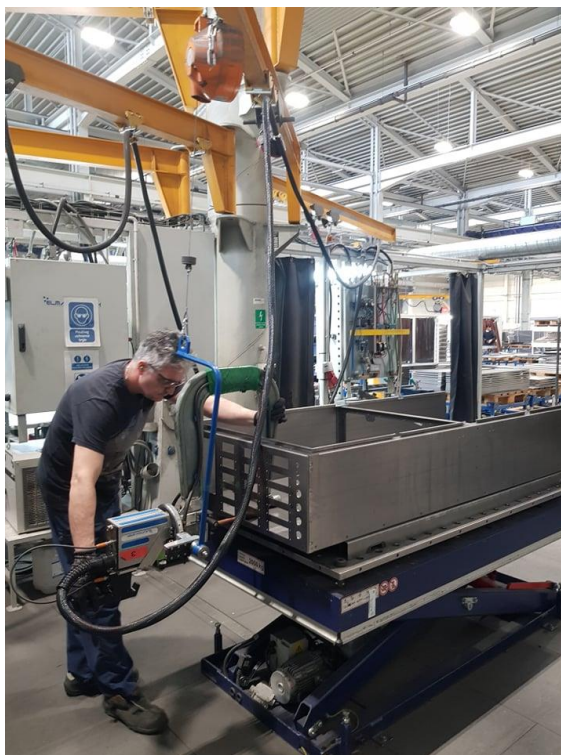
Obr. 8-3 Odporové (bodové) zváranie, zdroj: autor
