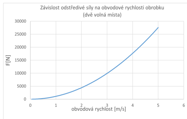
Obr. 113: Závislost odstředivé síly na obvodové rychlosti obrobku
