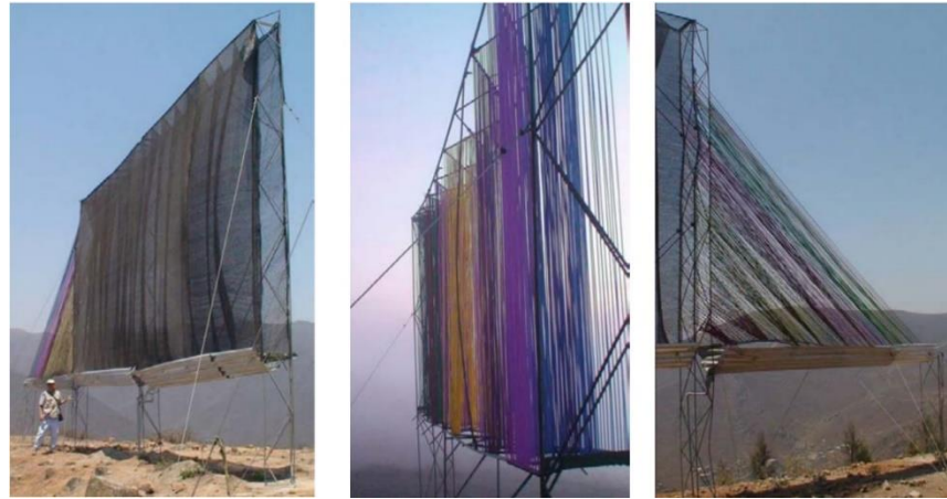
Obrázek 4 Kolektory Eiffel, Harfa a Diagonální harfa [17]
