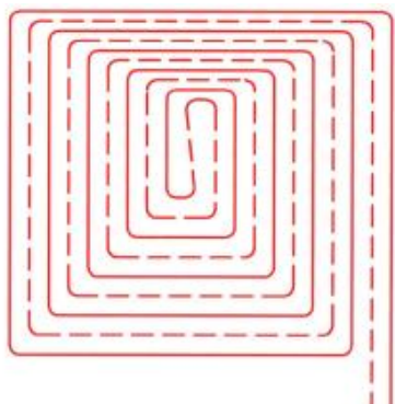
Obr 5-11 Příklad plošné spirály s intenzivní okrajovou zónou [9]
