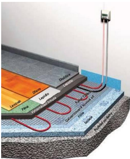
Obr 5-10 Konstrukce elektrického podlahového vytápění [11]
