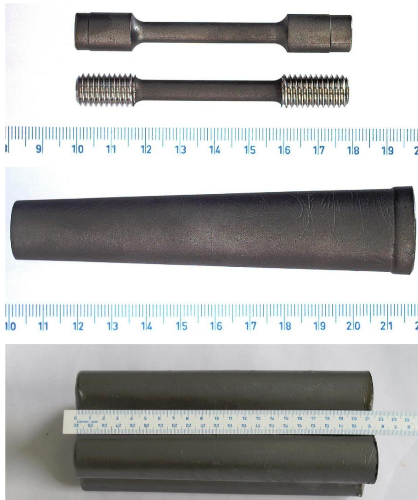
Obrázek 12 – Typy užitých odlitků – předlité (nahore), komolý kužel (střed) a čtyřlístek (dole)
