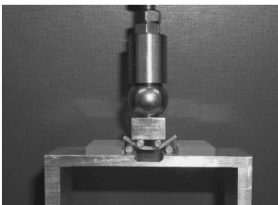
Obr. 19: Obdélníkový nosník ( 32 \times 2 \times 2 \text{ mm} ) testovaný na čtyřbodovém ohýbacím stole na zkušební stroji Hounsfield. Převzato z [2].
