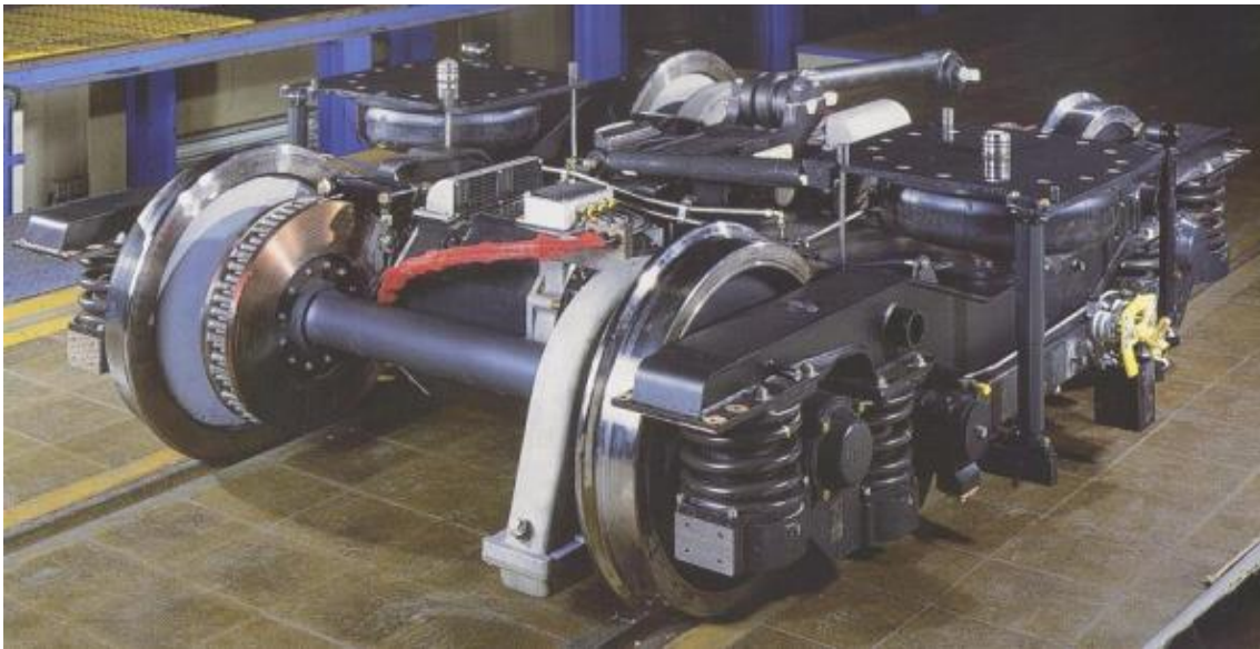
Obr. 4 - Vnější rám podvozku pražského metra soupravy M1 [4]
