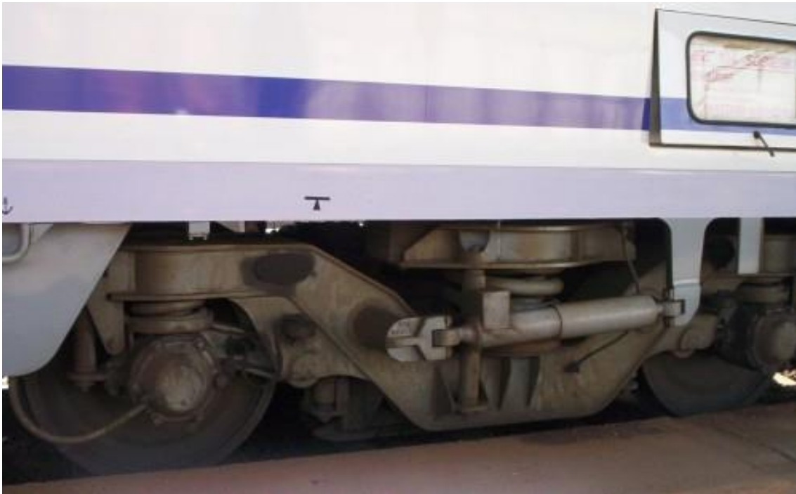
Obr. 11 - Bezkolébkový podvozek soupravy Fiat [8]
