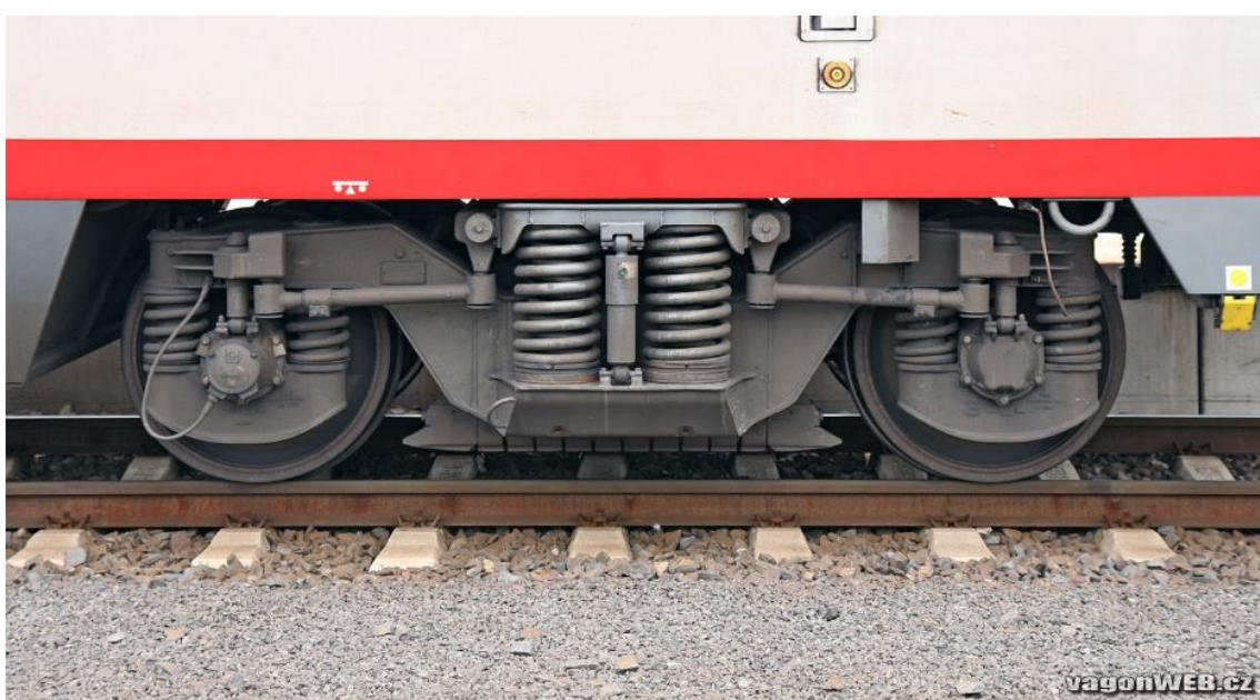
Obr. 15 - Dvoustupňové vypružení na podvozku SGP 300 [11]
