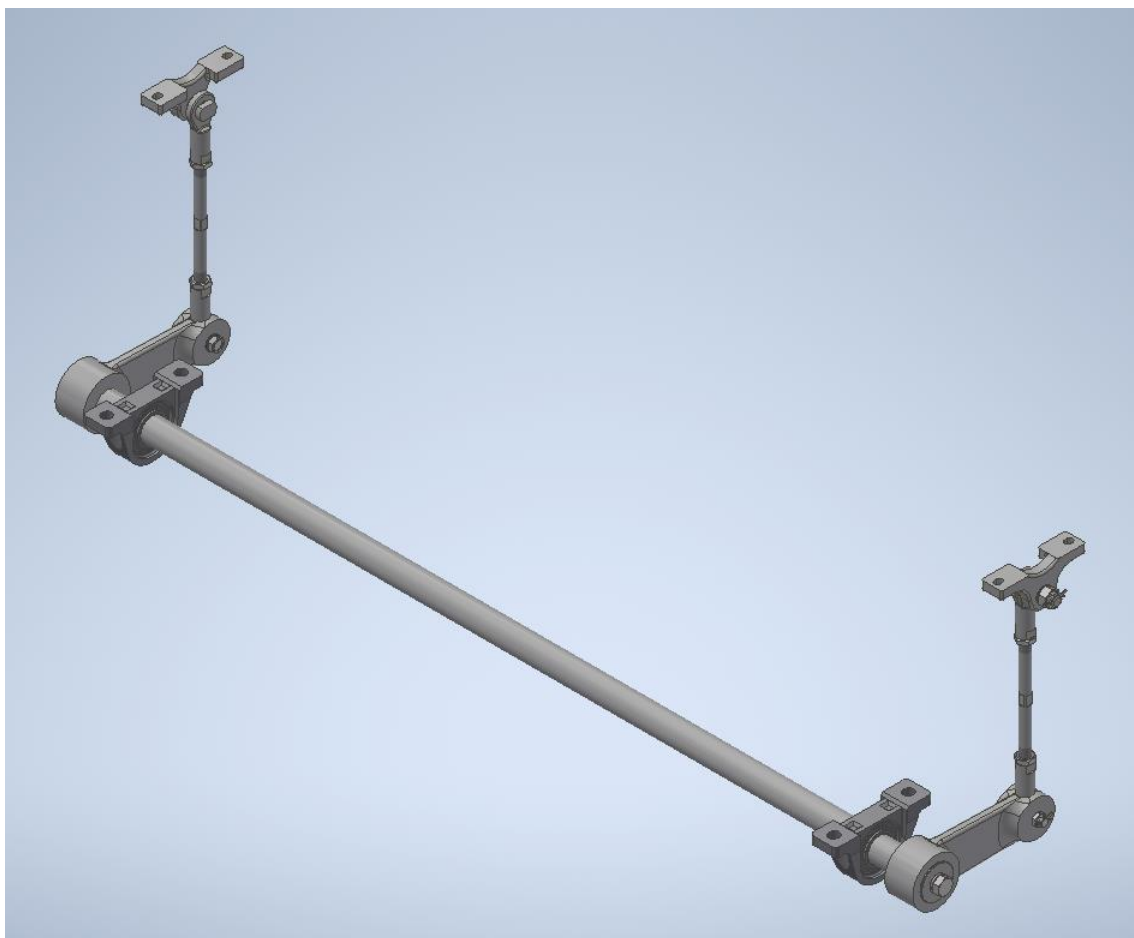
Obr. 47 - Model sestavy torzního stabilizátoru
