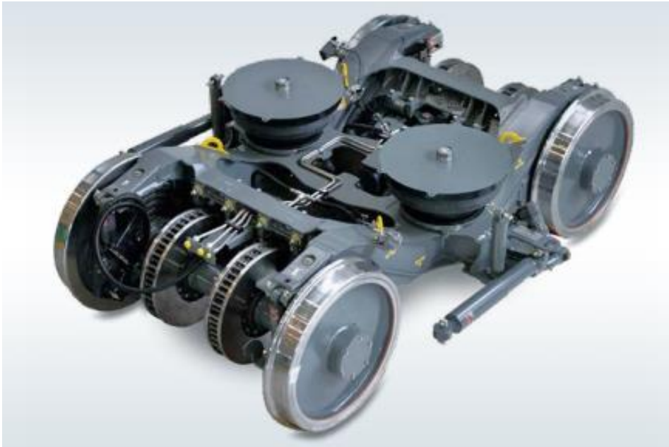
Obr. 6 - Vnitřní rám jednotky Mireo SF 7000 [5]
