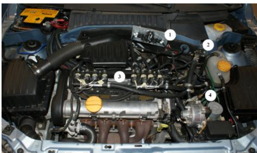
Obr. 3 - (1) - zapalovací modul, (2) - snímač tlaku, (3) - vstřikovače H 2 , (4) - tlakový regulátor [19]
