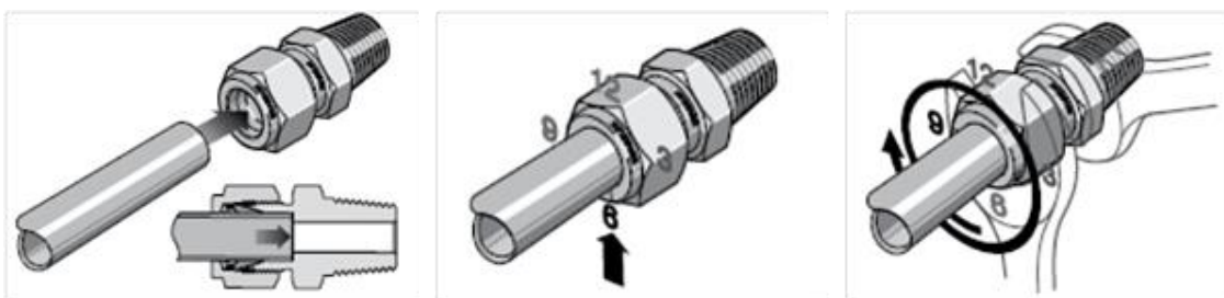
Obr. 19 - Schéma funkce a instalace šroubení Swagelok [30]
