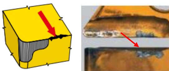
Obr. 35: Křehké porušení břitu na konci záběru [28]
