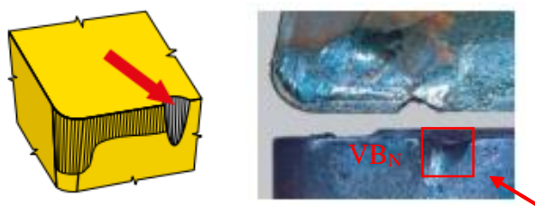
Obr. 33: Vrubové opotřebení hřbetu [28]
