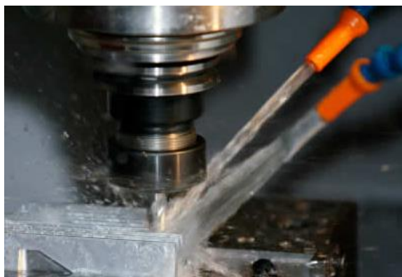
Obr. 26: Chlazení emulzní kapalinou při frézování [8]
