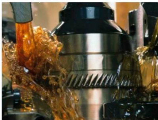
Obr. 27: Chlazení olejem při odvalovacím frézování [7]
