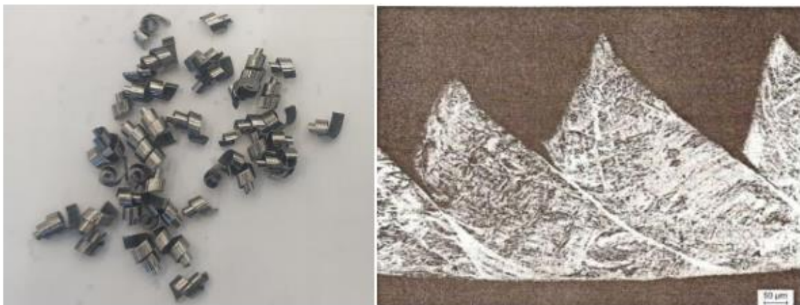
Obr. 16: Tvorba segmentované třísky během obrábění titanové slitiny [26]
