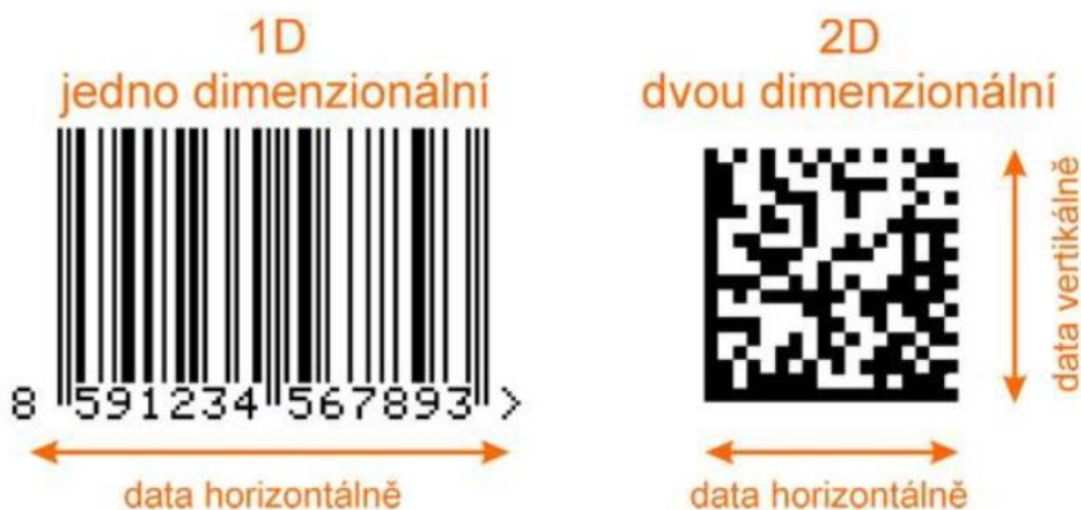
Obrázek 16 Rozdíl mezi 1D a 2D kódem [16]
