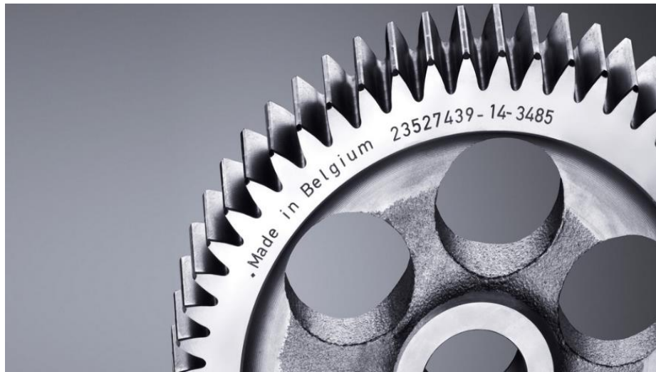
Obrázek 9 Značení pomocí metody gravírování laserem - černá struktura [21]
