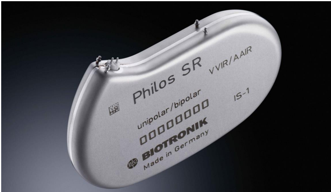
Obrázek 7 Značení pomocí metody žihání [21]
