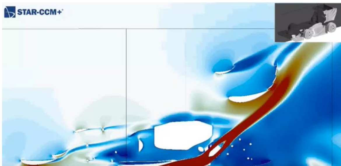
Obr. 9: Rozložení tlaku na voze týmu Rennstall Esslingen [9]
