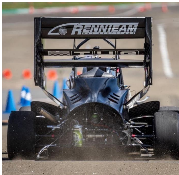
Obr. 10: Rennteam UNI Stuttgart s větráky v difuzoru [10]
