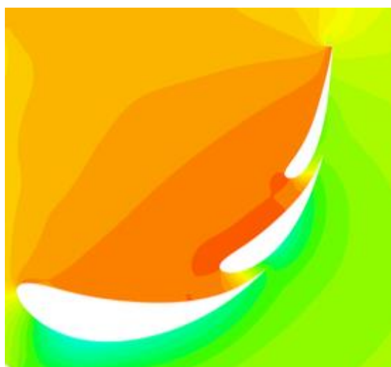
Obr. 5: Rozložení tlaků na zadním křídle vozidla FS14
