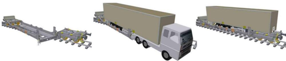
Obrázek 14 – Kinematické schéma systému Helrom [32]
