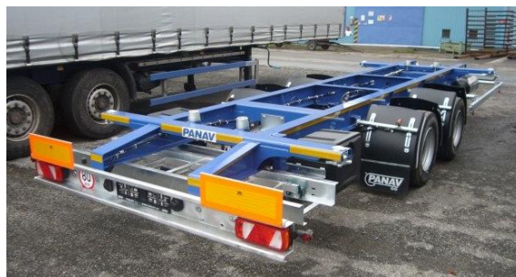
Obrázek 10 – Systém výměnné nástavby (vlevo) a její nosič (vpravo) [33] [34]
