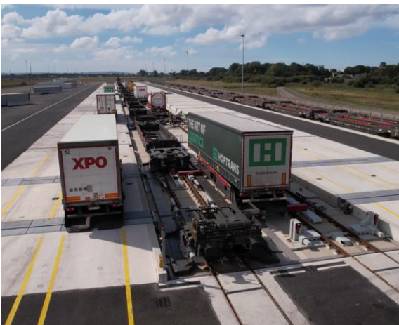
Obrázek 15 – Systém CargoBeamer, nakládka/vykládka (vlevo) [37] a koše (vpravo) [37]
