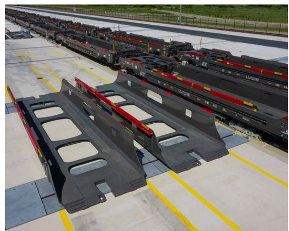
Obrázek 15 – Systém CargoBeamer, nakládka/vykládka (vlevo) [37] a koše (vpravo) [37]
