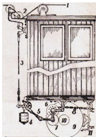
Obrázek 19 – Schéma provazcové brzdy [15]
