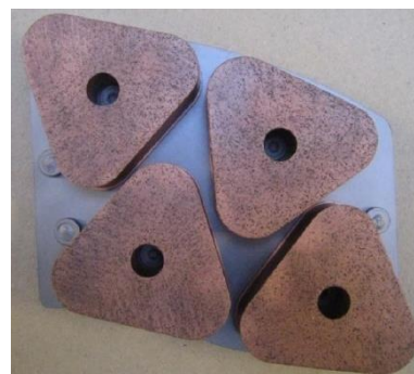
Obrázek 33 – Obložení brzdových čelistí tvořeno trojúhelníkovými segmenty
