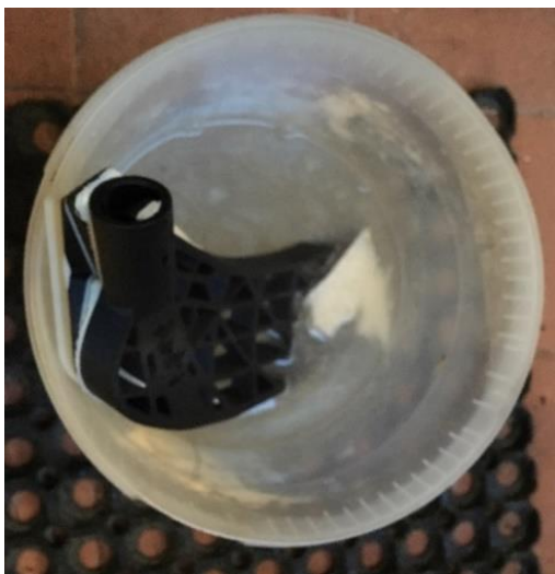
Obrázek 29 - rozpuštění podpor v lázni hydroxidu sodného
