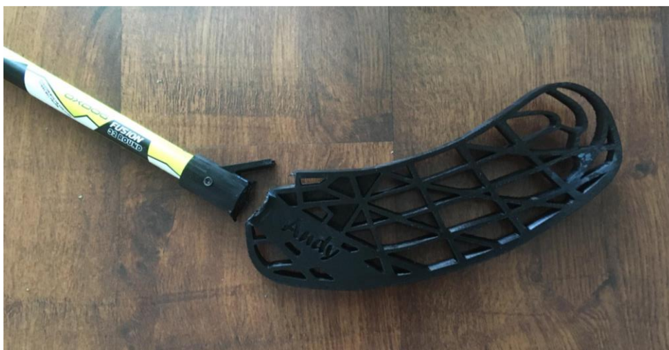
Obrázek 34 - detail prasklého místa (prototyp č. 1)
