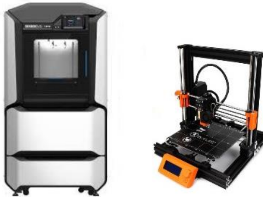
Obrázek 18 - tiskárny Stratasys F370 (vlevo) a Prusa MK3S (vpravo) [66] [67]
