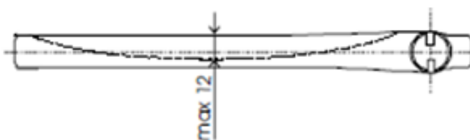
Obrázek 13 - maximální povolené zakřivení čepel dle IFF [53]
