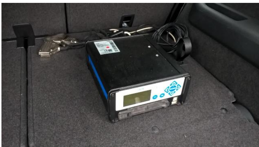
Obr. 18: Jednotka dataloggeru umístěná ve voze. Zdroj: Autor
