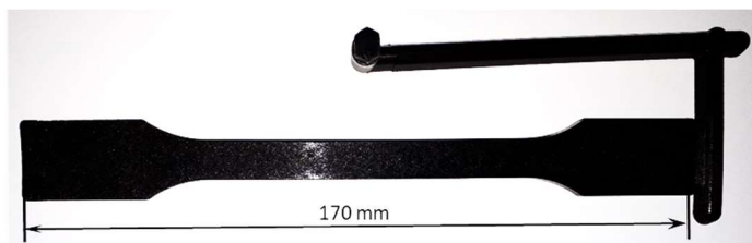
Obr. 13 - Zkušební těleso z EMS-Grivory Grilon TSG-30/4 black 9832
