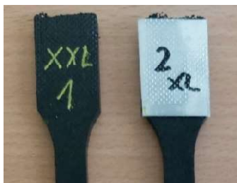
Obr. 14 – Zkouška tahem: zkušební těleso před a po lepení Al destiček
