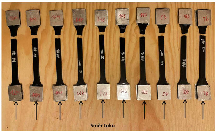
Obr. 11- Zkušební tělesa z materiálu PA-GF, které jsou přerušena mezi segmentem č. 5 a č. 6
