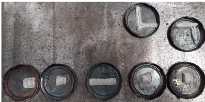
Obr. 17 - Sedm segmentů podle Obr. 16 po spálení - bílá hmota v kelímcích jsou zbytky skleněných vláken
