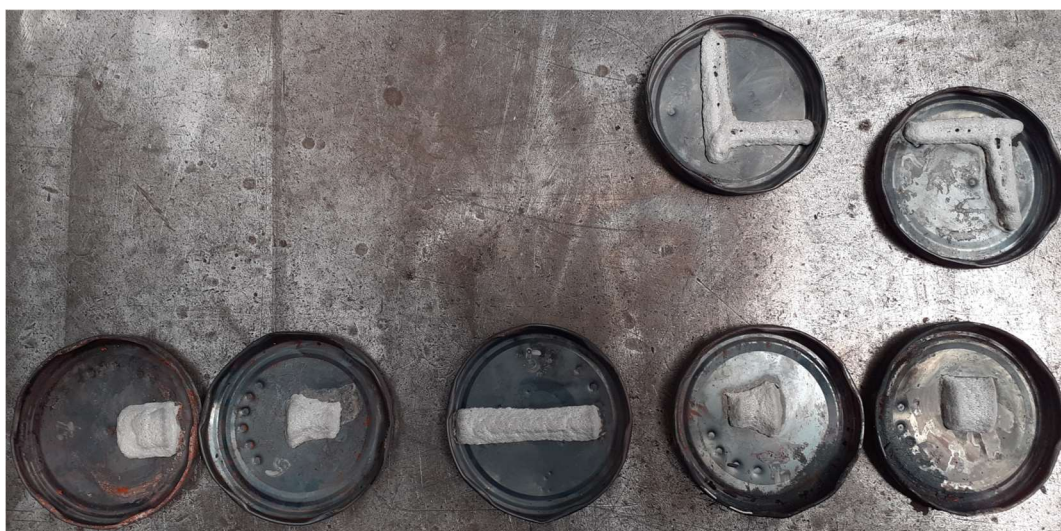
Obr. 61 - Sedm segmentů z Obr. 60 po spálení - bílá hmota v kelímcích jsou zbytky skleněných vláken
