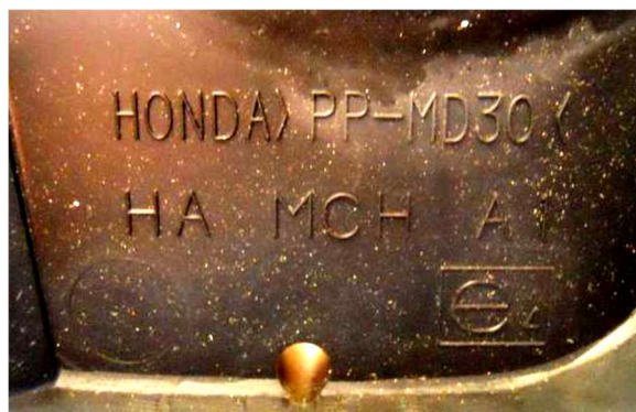
Obr. 28 - Označení komponent kódem normy ČSN EN ISO 16396-1:2015 „Plasty - Polyamidy (PA) pro tváření - Část 1: Systém označování, značení výrobků a základy pro specifikace“ [N6] Součást automobilu: Polypropylen + 30 % mletého masku
