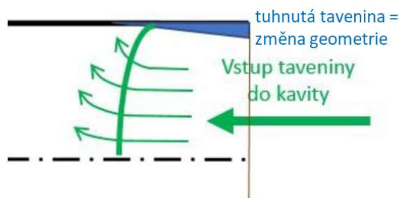
Obr. 14 - Fontánový efekt u vstupu taveniny do kavity
