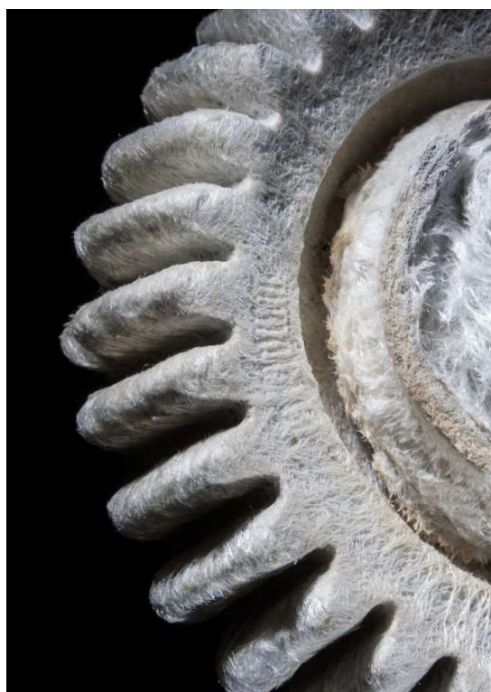
Obr. 58 - Ozubené kolo vyrobené z PA-GF před a po spalování (vpravo) [31]
