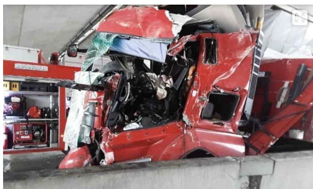
Obrázek 40 – Ukázka DN po střetu kabiny TNA s mostním pilířem. [41]
