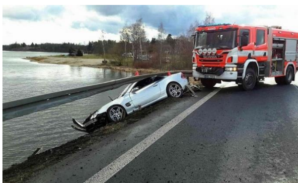
Obrázek 38 – Podjetí ocelového svodidla na hrázi vodní nádrže. [40]
