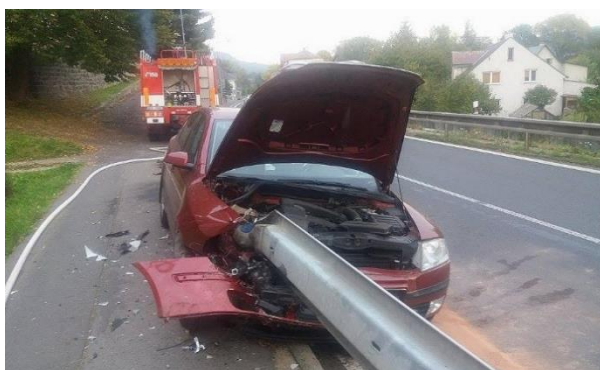
Obrázek 36 – Čelní náraz do svodidla s krátkým výškovým náběhem. [40]
