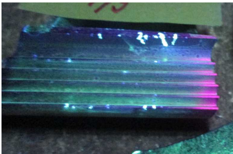
Obr. 8.2: Lineární indikace kolmé na směr broušení na rámečku lopatky
