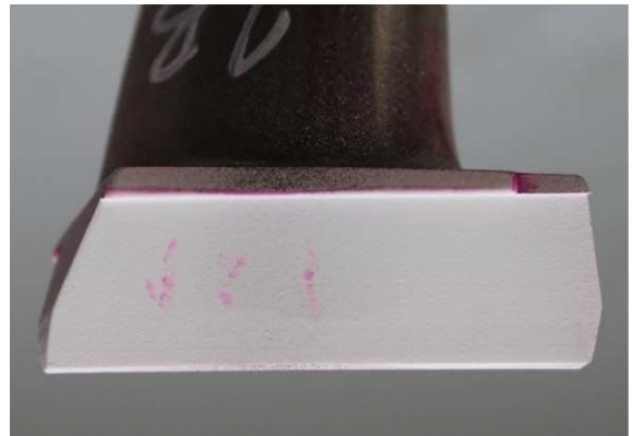
Obr. 8.7: Slabé liniové indikace na kapilární zkoušce
