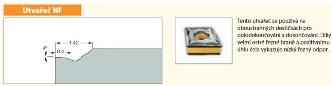
Obr. 7.3: Geometrie utvařeče NF v rovině ortogonální [82]
