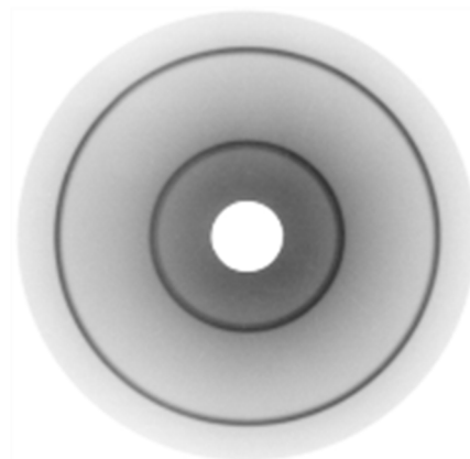
Obr. 2.16: Difrakční (Debye-Scherrerův) kroužek (vpravo) [34]
