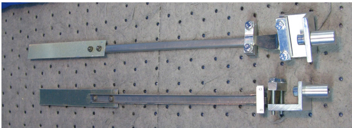
Obr. 4.4: Měřící ramena připevněná na vzorcích
