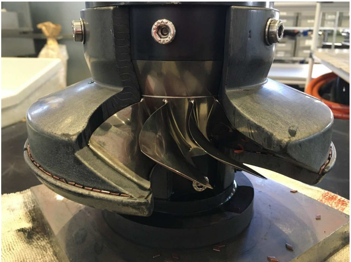
Obr. 6.3: Využití FDM technologie k výrobě krycích tvarových segmentů maskování lopatek
