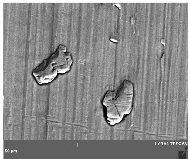
Obr. 2.2: SEM Ti-6Al-4V - zrna brusiva zaražená v základním materiálu
