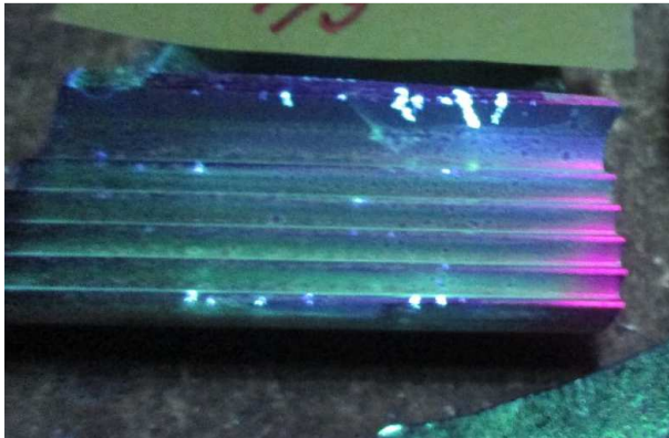
Obr. 8.6: Lineární indikace kolmé na směr broušení na rámečku lopatky
