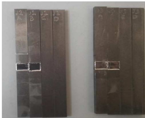
Obr. 4.18: Pásky o rozměrech 80x5x4 mm odebrané se středu zpevňované destičky
