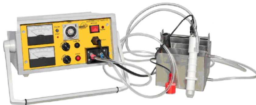
Obr. 4.26: Příklad pro elektrolytické leštění – příslušenství difraktometru.
