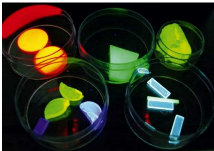
Obrázek 1: Ukázka skleněné keramiky dopované kovy vzácných zemin pro vzestupnou a sestupnou konverzi [4]
