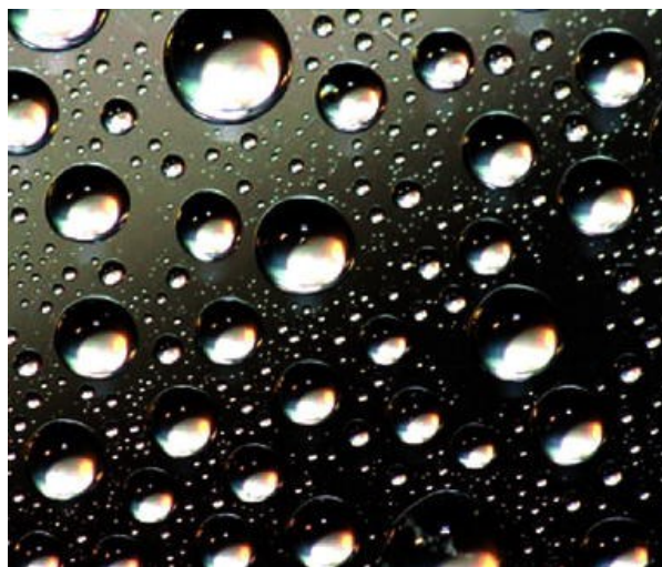
Obrázek 2: Důsledek samočisticí a antireflexní nanovrstvy [6]
