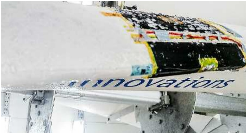
Obrázek 6: Ukázka nového energeticky účinného topného systému, který dokáže během několika sekund rozpustit led na větrných turbínách. Povlak z uhlíkových nanotrubiček zahřívá definované oblasti lopatek rotoru, jakmile integrované senzory zjistí námrazu.[4]
