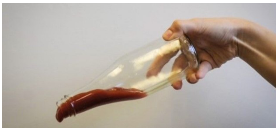
Obrázek 9: Ukázka nanovrstvy, která vytváří samomazný povrch [61]
