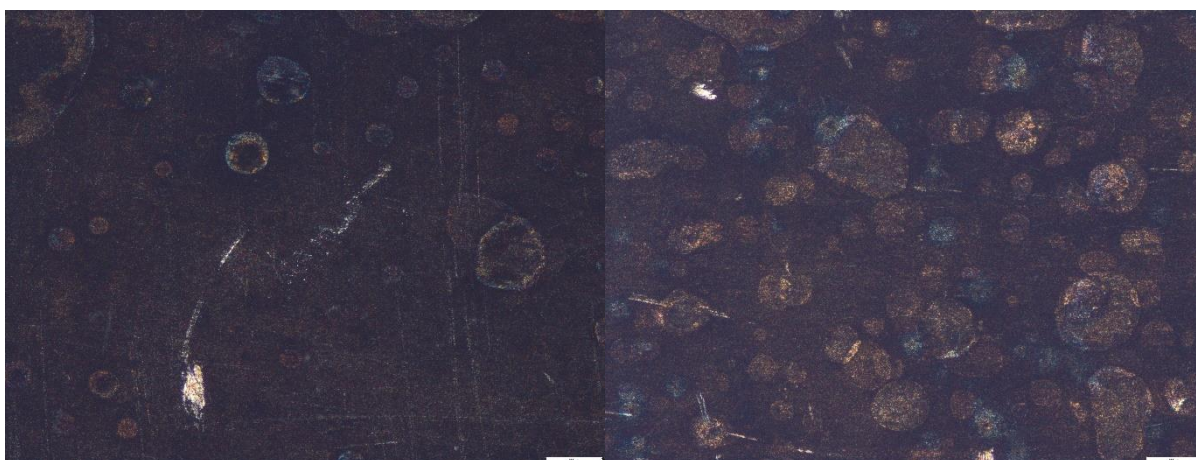
Obrázek 6C – Snímky z mikroskopu materiálu Inconel 718 AM po vystavení teplotě 700 °C v tekuté soli NaF-NaBF 4 po dobu 720 h
