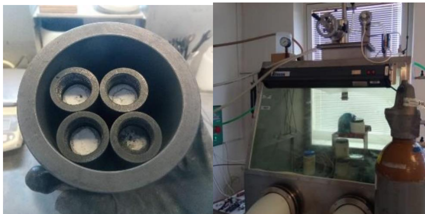
Obrázek 20 – Fotky z přípravy měření: a) Záchytný grafitový kelímek s čtyřmi grafitovými kapsulemi obsahující vzorky s zalité tekutou solí NaF-NaBF 4 ; b) Rukavicový box [10]
