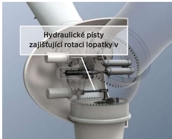
Obrázek 50: Detail hydraulického mechanismu natáčení úhlu náběhu listů lopatek [36]
