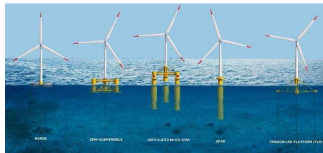
Obrázek 11: Plovoucí OFFS turbíny s různými druhy plovoucích základů [21]
