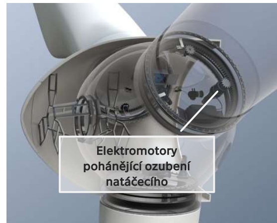
Obrázek 51: Detail elektrického mechanismu natáčení úhlu náběhu lopatek [36]
