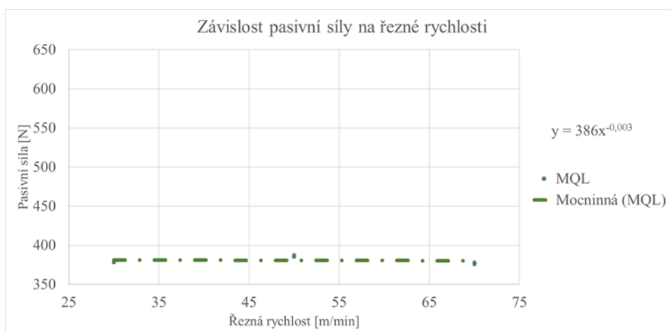
Graf 14 Závislost pasivní síly na řezné rychlosti MQL
