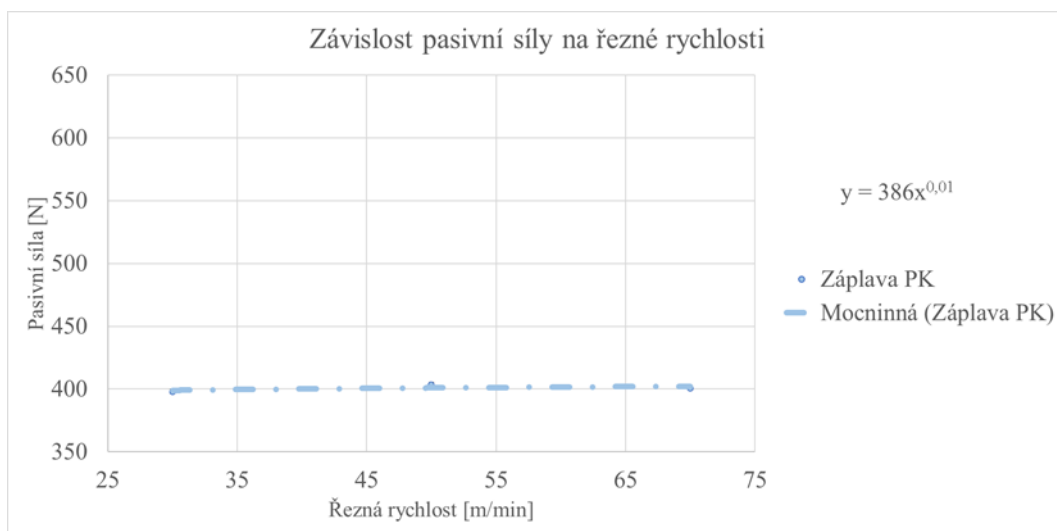
Graf 17 Závislost pasivní síly na řezné rychlosti při záplavě PK
