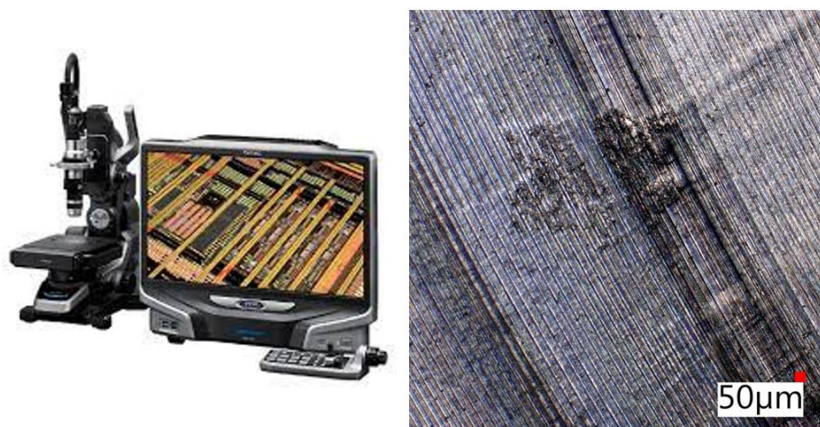
Obr. 40 Digitální mikroskop s ukázkou vyhodnocení struktury obrobené plochy [37]
