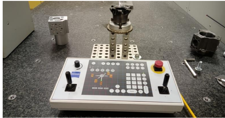
Obr. 31 Měření úhlů obráběcí hlavy
