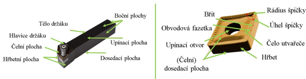
Obr. 8 Soustružnický nůž s destičkou (Upraveno) [18]
