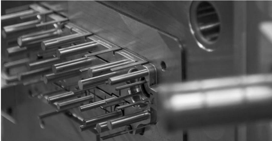
Obrázek 12: Pohled na vyhazovače a vratné kolíky [4]
