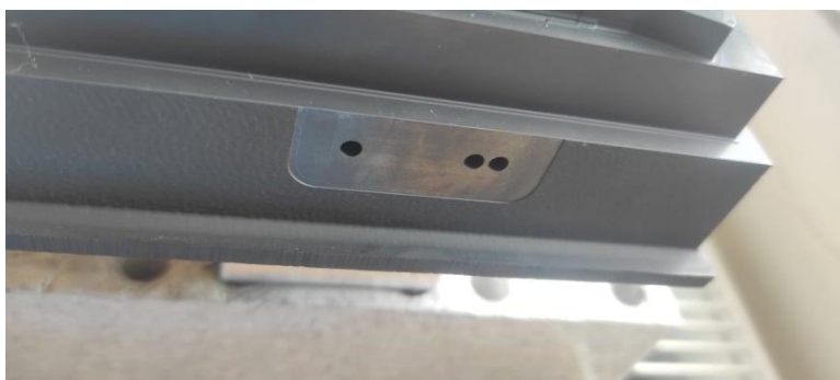
Obrázek 19: Příklad vyplachovacích otvorů [autor]
