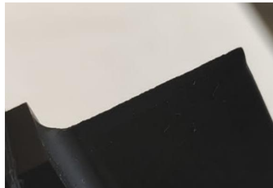
Obrázek 21: Detail vyštípnuté elektrody-2 [autor]
