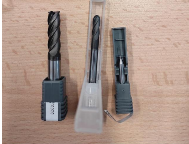
Obrázek 23: Ukázka fréz používaných k frézování grafitu [autor]
