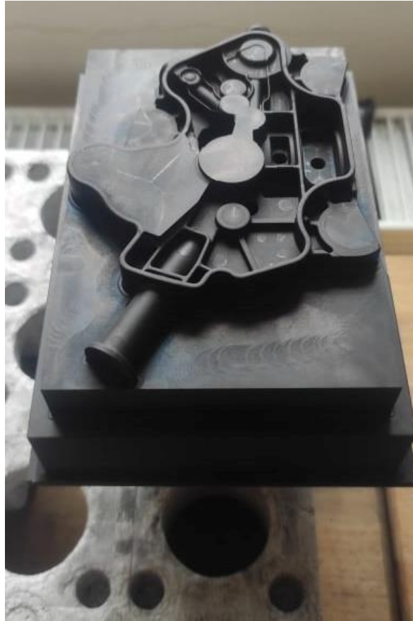
Obrázek 17: Příklad tvarově složité elektrody [autor]
