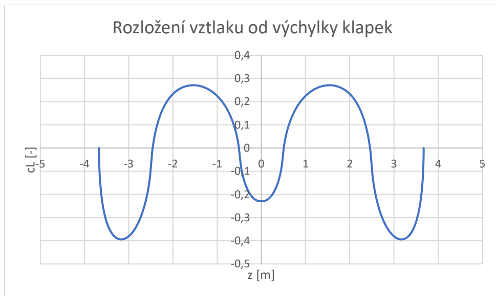
Obrázek 55: Rozložení vztlaku od výchylky klapek
