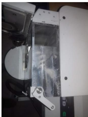
Obrázek 3 Deska mlýna po odmontování násypky
