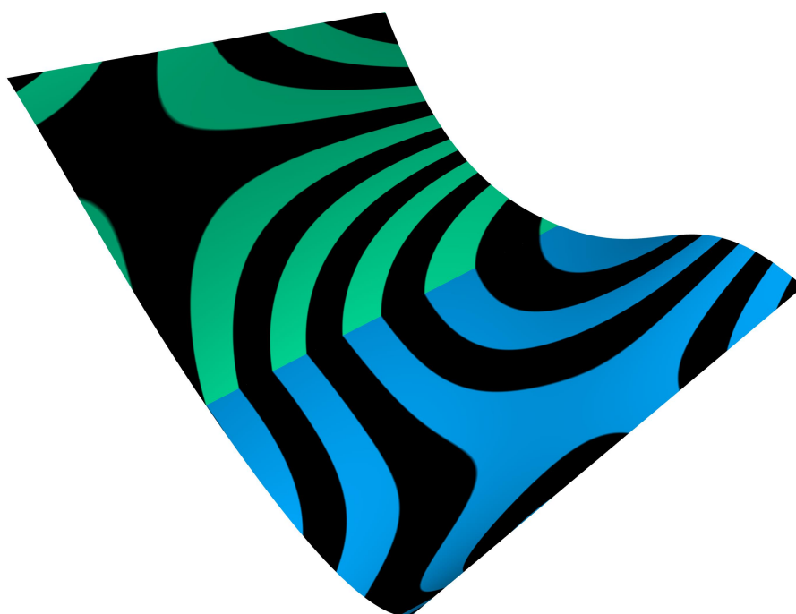
Obrázek 3.5: Analýza min. G^1 napojení dvou plátů zobrazením pruhů zebry
