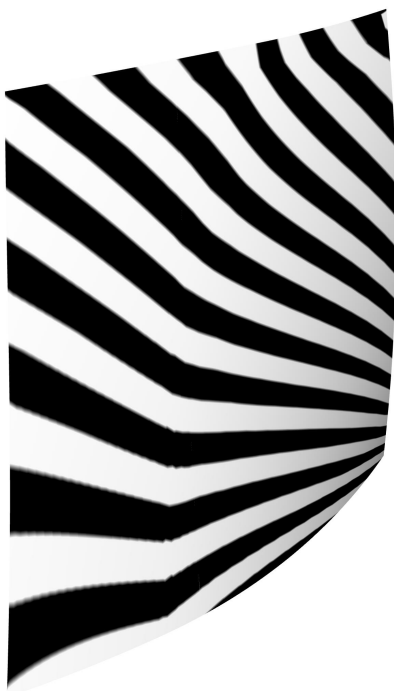
Obrázek 10.2: Analýza sací strany lopatky zobrazením pruhů zebry
