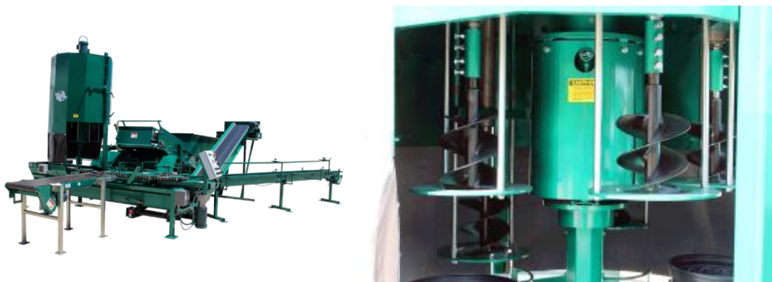
Obrázek 8: Vlevo plnič Bouldin&Lawson, vpravo detail vrtací jednotky plniče [10]
