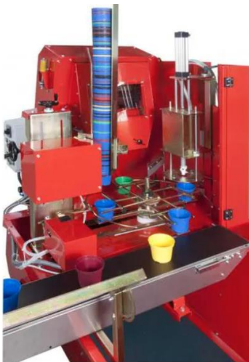
Obrázek 7: Plnič italské firmy Mosa Green v karuselovém uspořádání [9]
