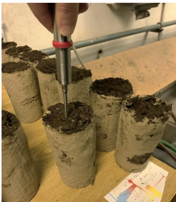
Obrázek 26: Měření tlaku potřebného pro vnik měřicího tělíska penetrometru do substrátu
