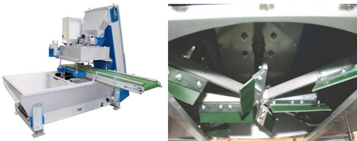
Obrázek 2: Vlevo – plnič pěstebních nádob, vpravo detail rotoru s gumovými klapkami plniče pěstebních nádob Quick Filler firmy VISSER, Holandsko [3]
