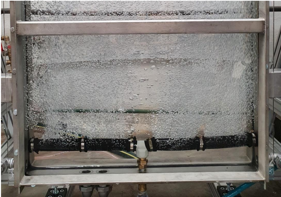
Obr. 25 Bubliny způsobené netěsností
