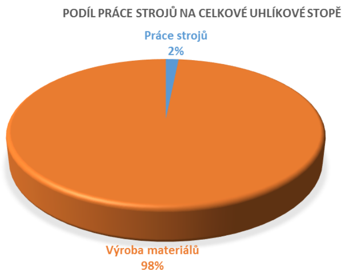
Obr. 36: Podíl materiálů a práce strojů na celkové uhlíkové stopě
