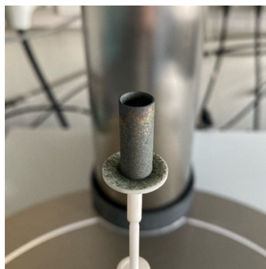
Obr. 3.13: Pozorované odpadávání oxidu z povrchu vzorku při teplotě 1200 °C.
