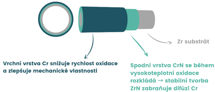
Obr. 1.5: Vícevrstvý povlak Cr a CrN na palivovém pokrytí
