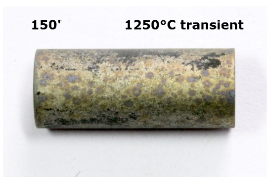
Obr. 3.11: Vzorek z Cr-Ni slitiny po přechodovém experimentu vysokoteplotní oxidace.
