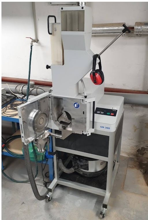
Obr. 37: Zapojení sestavy nožového mlýnu
