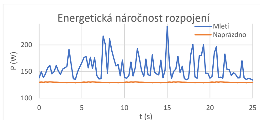
Obr. 59: Energetická náročnost rozpojení částic na ultraodstředivém mlynu po průchodu mlynem nožovým
