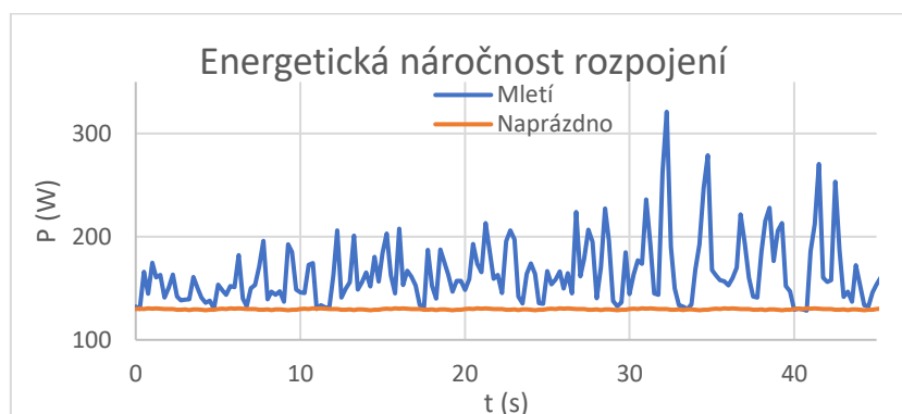
Obr. 60: Energetická náročnost rozpojení částic na ultraodstředivém mlýnu při přímém průchodu cvrčka domácího
