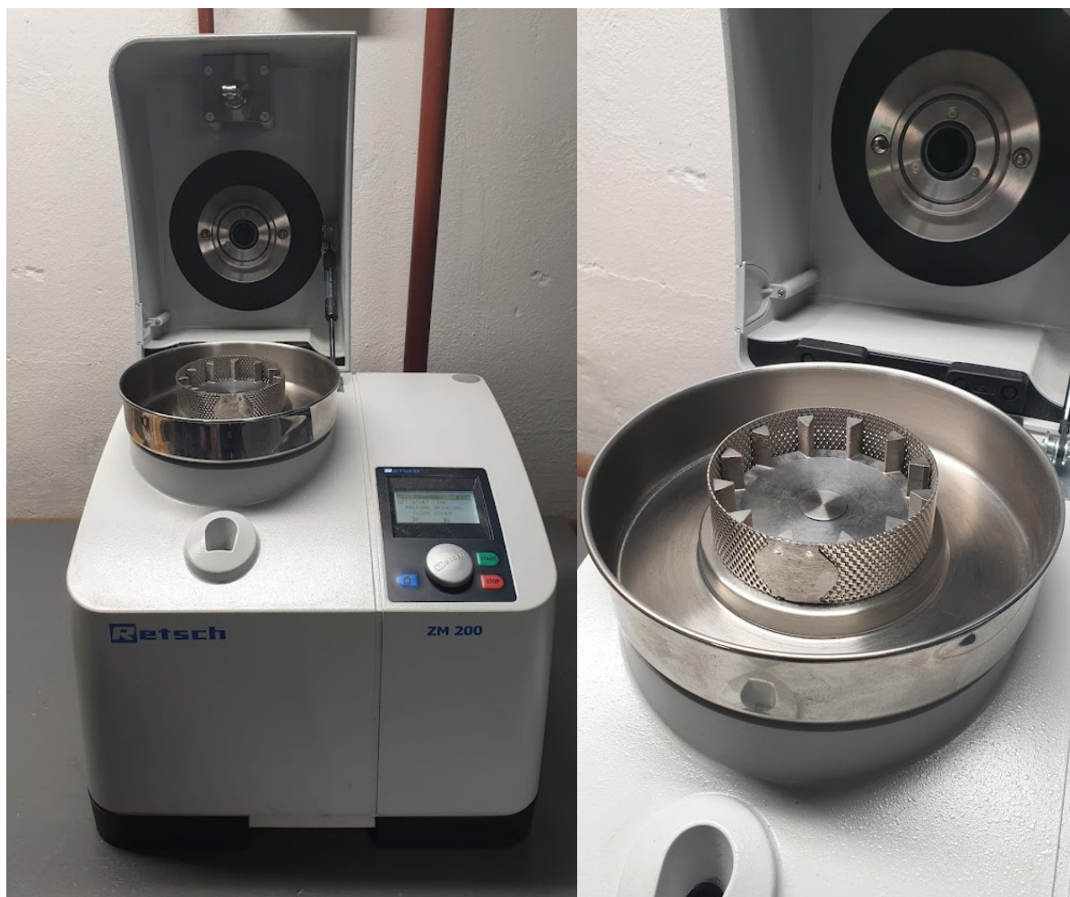
Obr. 47: Konfigurace ultraodstředivého mlýnu Retsch ZM 200
