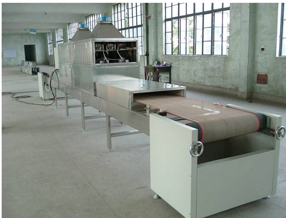
Obr. 15: Experimentální linka na mikrovlnné sušení Shandong Agricultural University [25]
