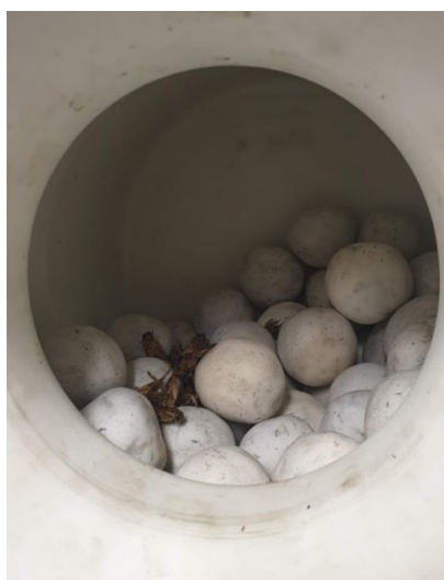
Obr. 35: Mletí v keramickém mlýnu
