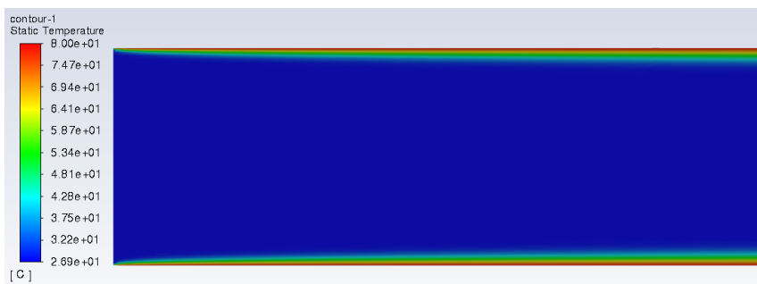
obr. 29: Rozložení teplotního pole podél teplosměnné plochy – nucená konvekce newtonských kapalin
