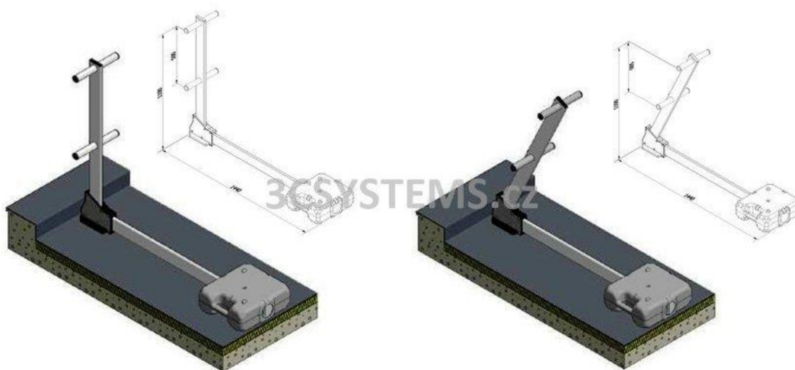
Obrázek 1. Bezpečnostní střešní zábrana, volně stojící VarioRail – ALU Stabil 24 [3]
