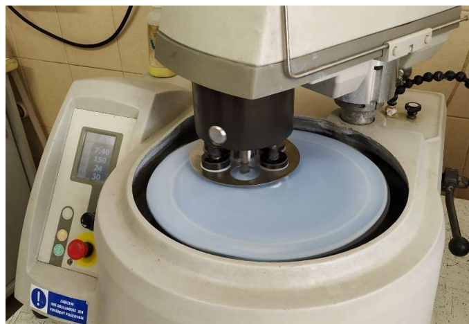
Obr. 24 Leštění vzorků na leštičce LECO GPX 300
