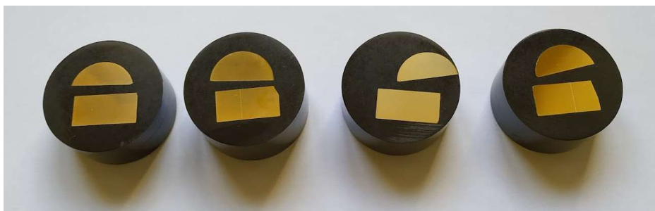
Obr. 25 Vyleštěné metalografické vzorky zalisované do prskyřice (zleva vzorky F10, F15, F20 a F10/10)
