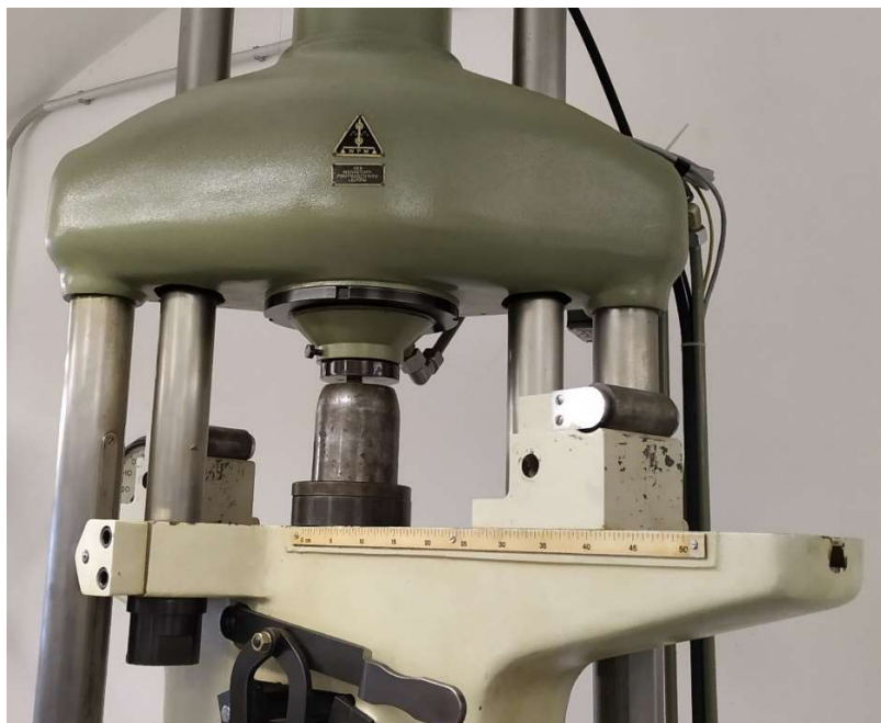
Obr. 22 Univerzální trhací stroj Werkstoff-Prüfmaschinen ZDM 50
