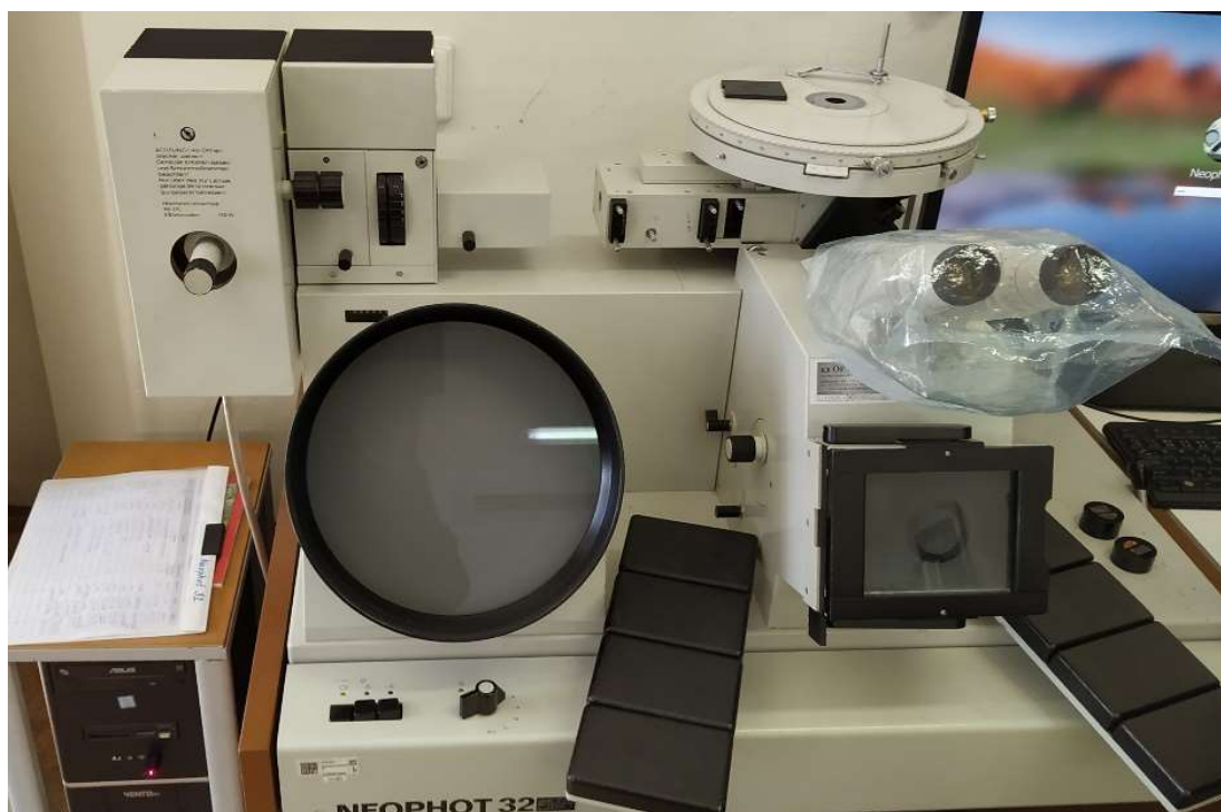
Obr. 26 Metalografický mikroskop Neophot 32 vybavený CCD kamerou
