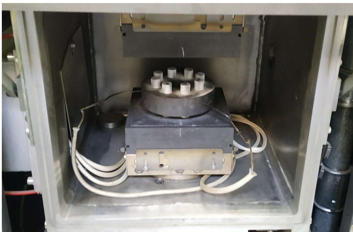
Obr. 18 Umístění formy do sintrovací komory lisu DSP 515
