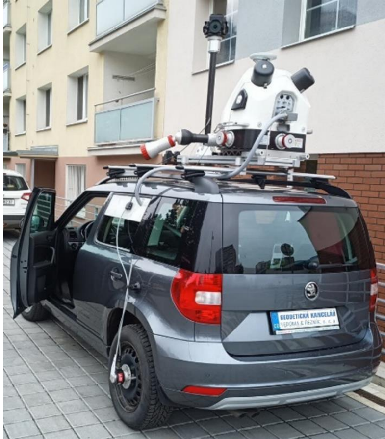
Obrázek 14: Škoda Yeti 2.0 TDi 81kW 4x4, osazena Riegl VMX-2HA
