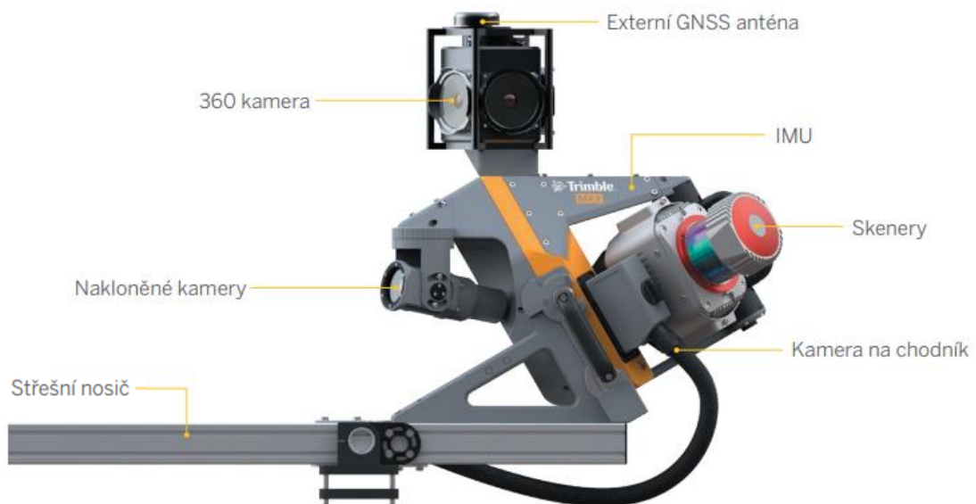
Obrázek 2: Složení MMS Trimble MX9 [1]
