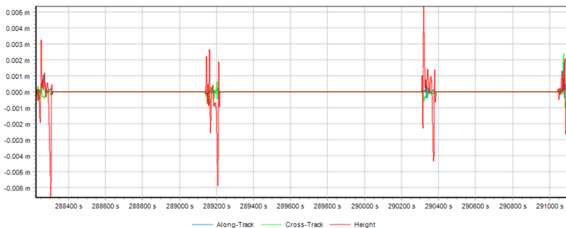
Obrázek 24: Graf polohových oprav trajektorie, vygenerované do RiPRECISION report
