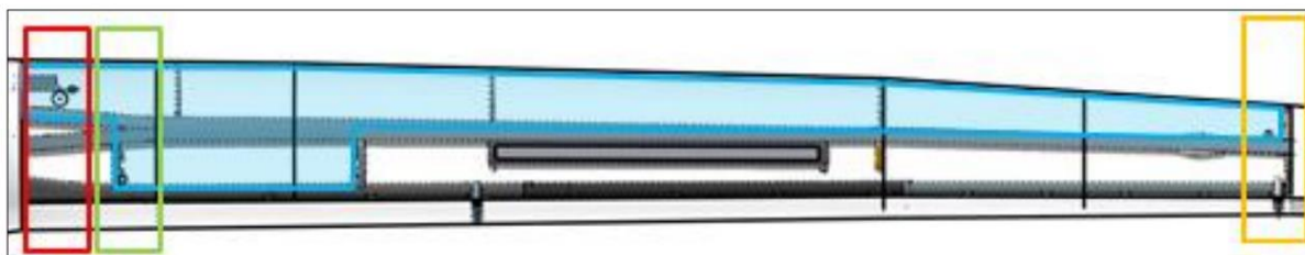
Obrázek 9: Vodní nádrž v hlavním křídle JS3 [17]
