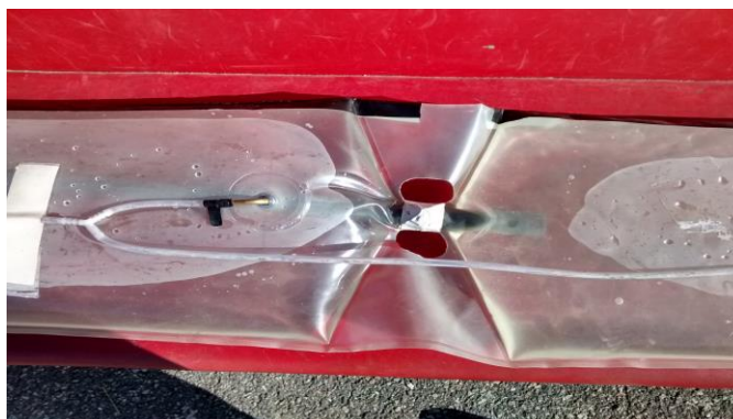
Obrázek 11: Vak na vodní zátěž ASW 24
