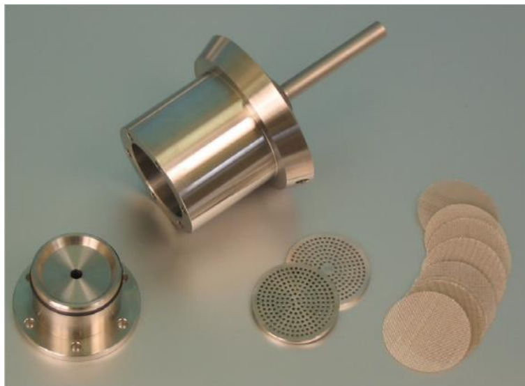
Obrázek 8 - Součásti zapalovače využívající katalytický rozklad peroxidu vodíku [11]
