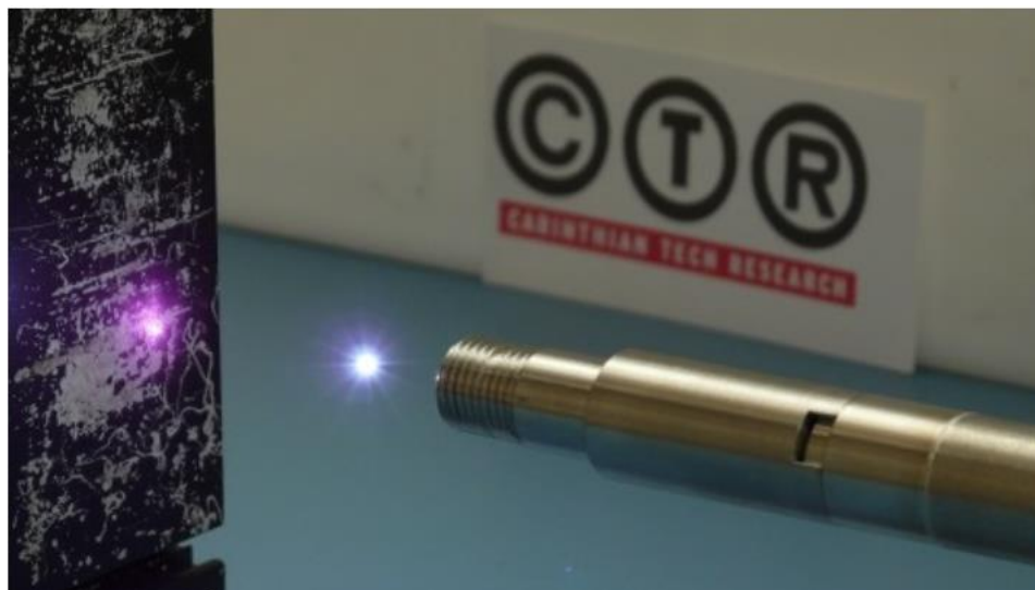
Obrázek 7 - Ionizace nosného plynu v ohnisku laseru [10]
