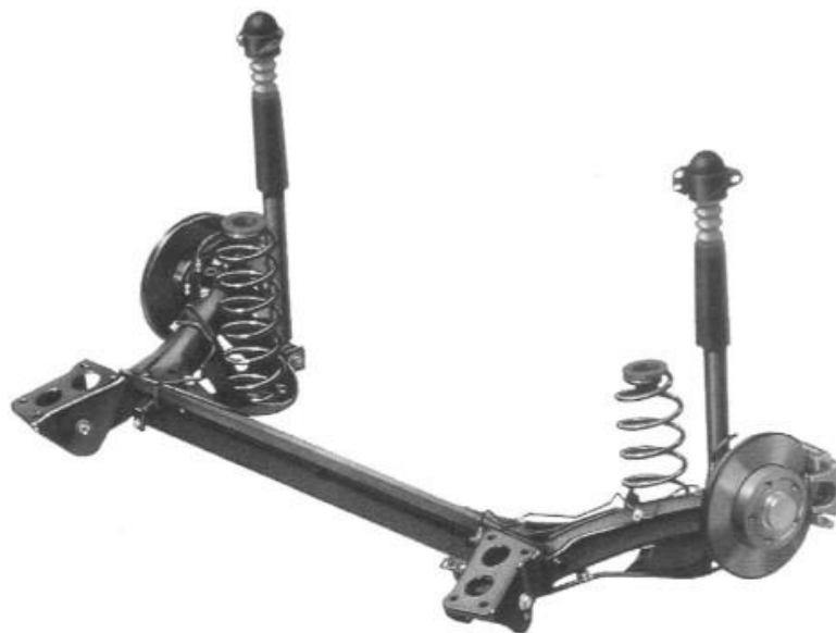
Obrázek 7 - Zavěšení kol torzní příčkou, zadní náprava VW Golf [5]
