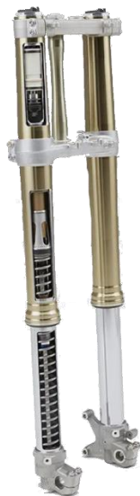
Obrázek 9 - Teleskopická vidlice motocyklu, invertovaná [8]
