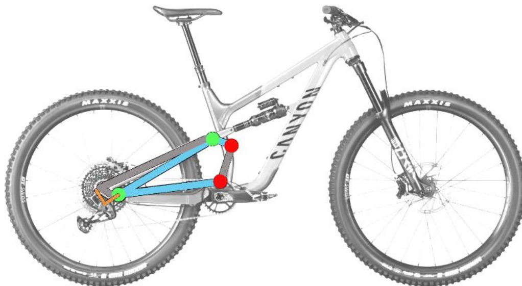
Obrázek 26 – Zobrazení parametrizace mechanismu a fotografie kola Canyon Spectral
