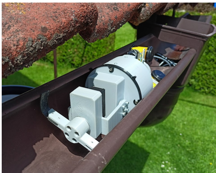
Obr. 30: Vodorovný pohyb robota v reálném žlabu
