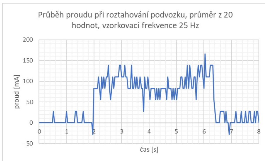
Graf 2: Měření proudu při roztahování, vzorkovací frekvence 25 Hz
