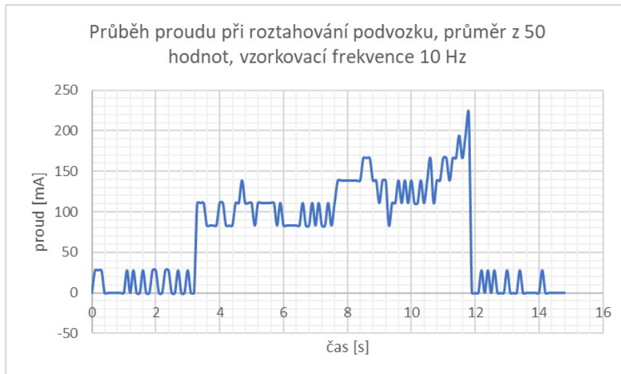
Graf 3: Měření proudu při roztahování, vzorkovací frekvence 10 Hz
