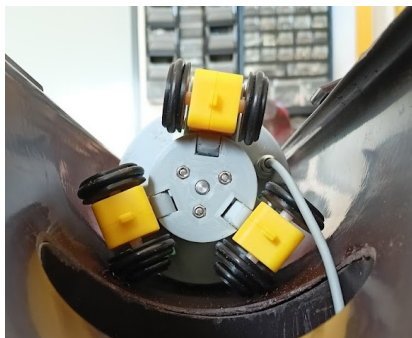
Obr. 27: Pohled na kontakt koleček se žlabem
